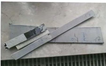
Ergebnis: Eine homogene Verbindung war auf der gesamten Nahtbreite nicht vorhanden. Die Nahtverbindung ist unbrauchbar.
